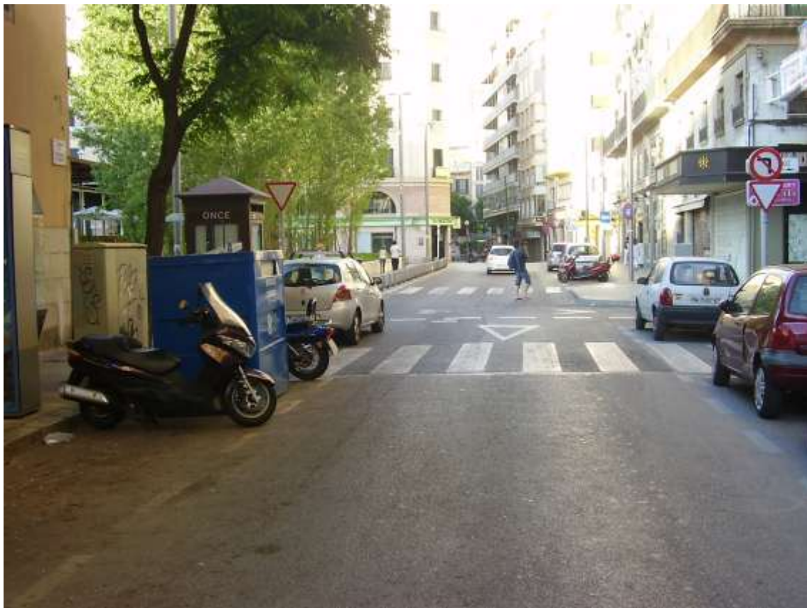
Fig. 19 – Encreuament dels carrers Velázquez i Josep Tous i Ferrer, on el mobiliari urbà impedeix una adequada visibilitat dels cycles que arriben per l’esquerra –des d’on normalment arriba poc trànsit-, generant un alt risc de col·lisió i poca definició de les prioritats de pas.
